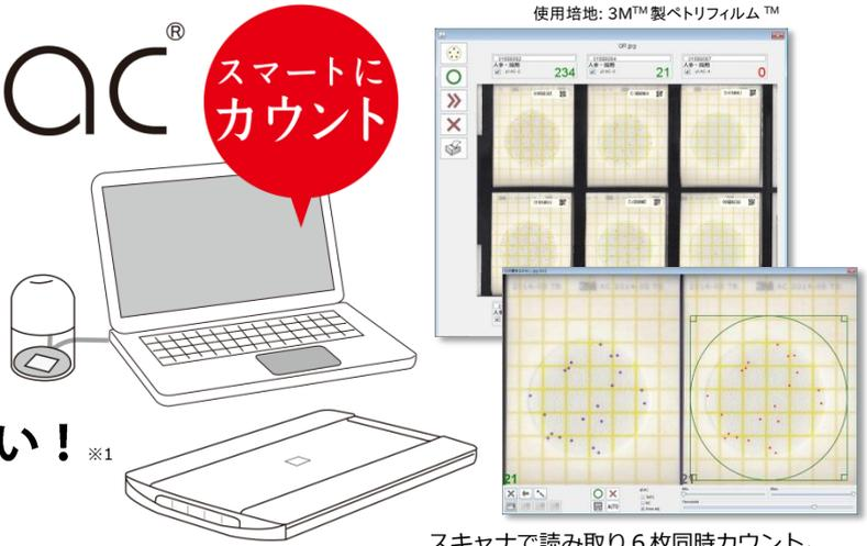
スキャナで読み取り6枚同時カウント。画像をクリックすると手動修正ができます。
