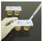
XM-30 の場合は検液 1mL XM-31 の場合は検液 10mL XM-32 の場合は検液 5mL を注入します
